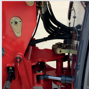
Knickpendelgelenk für mehr Flexibilität und Bodenhaftung
