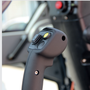
Joystick-Steuerung und elektronische Gangschaltung
