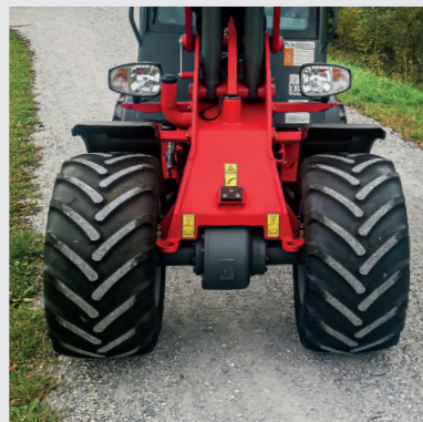
Frei zuschaltbare Differenzialsperre für maximale Kraftübertragung
