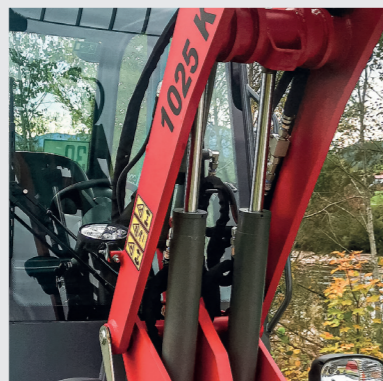
Zwei Hubzylinder für optimale Lastenverteilung
